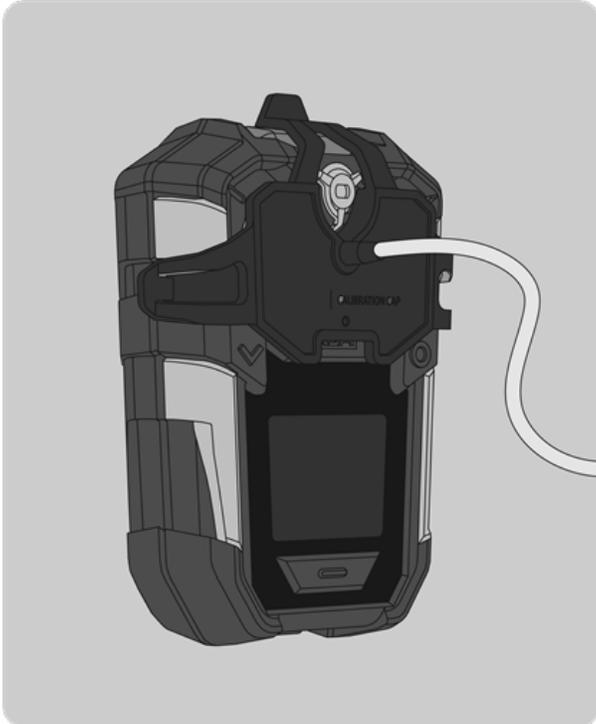
e) Conecte un extremo del tubo al cabezal de calibración.
